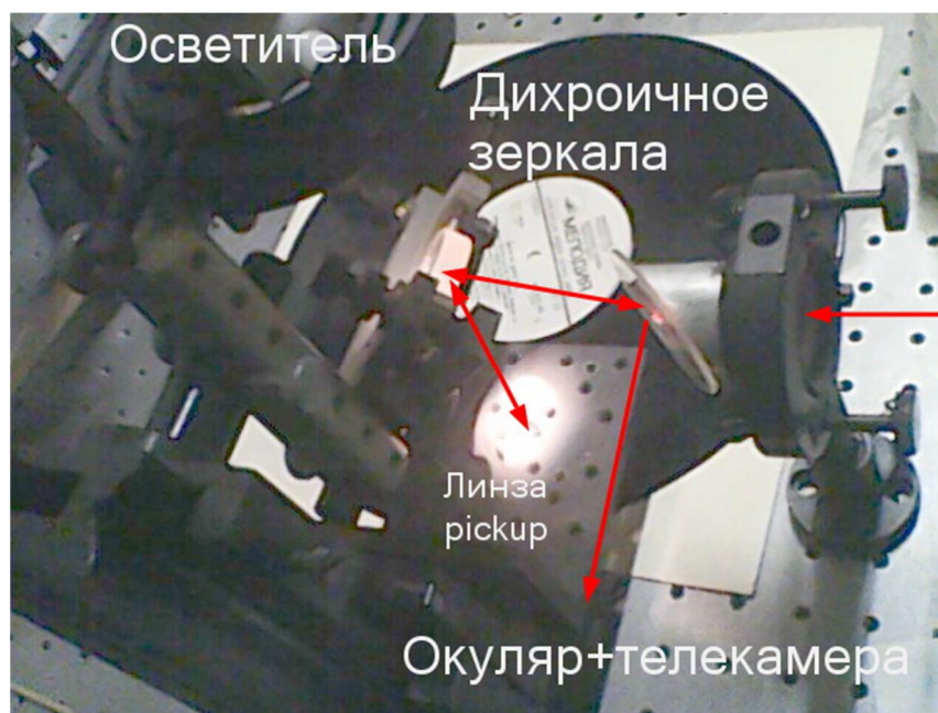
Рисунок 1. Оптический стенд для изучения дифракции.
